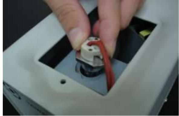
7 向下壓並旋轉 90 度至燈座和治具至固定位置。
